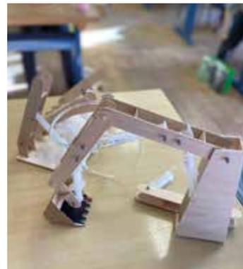
Es wurde geplant, gemessen, gebohrt, Holz zugeschnitten und vieles mehr. Was für die Kinder anfangs unmöglich erschien, wurde am Ende ein funktionierender Hydraulik Bagger, den sie mit nach Hause nehmen konnten.
