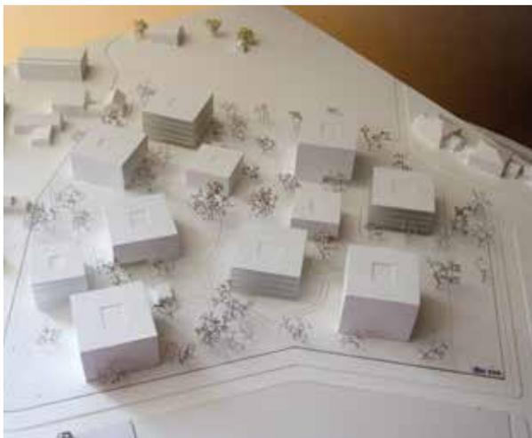
Demnach sind auf dem gegenständlichen Wettbewerbsareal mit einer Fläche von ca. 22.300 m<sup>2</sup>, 11 quadratische Punktbaukörper mit verschiedenen Breiten und Höhen geplant. Die Baukörper sind als 3- bis 6-geschossige Objekte vorgesehen. Die erforderlichen PKW-Stellplätze sind in 3 Tiefgaragen sowie 3 Außenstellplatzbereichen berücksichtigt. Neben den Haupteinschließungswegen für die einzelnen Baufelder bestehen zusätzlich auch geschwungene Fußwege mit einem kleinen mittigen Zentrum (Park).
