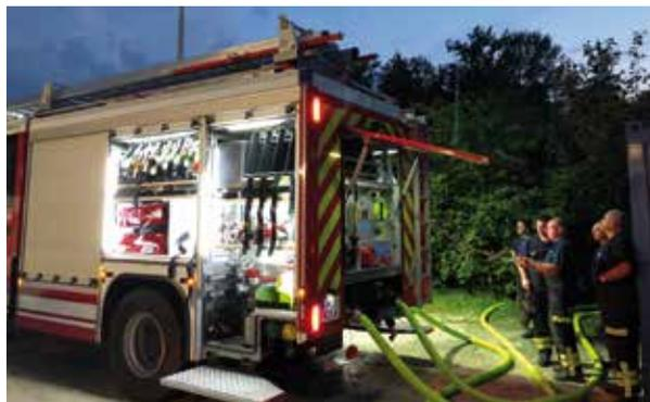
Mit der Tragkraftspritze wurde das Wasser aus dem Mühlbach angesaugt. Mithilfe der B-Schläuche wurde das Wasser dann weitertransportiert. Diese Pumpenschulungen sind äußerst wichtig da im Ernstfall das Wasser rasch an der Einsatzstelle benötigt wird, um in entlegenen Gebieten in denen kein Hydranten Netz besteht die Wasserversorgung bei einem Brandeinsatz aufrecht halten zu können.
