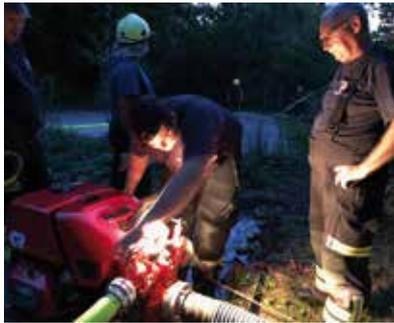
Eine äußerst wichtige Gerätschaft sind die verschiedensten Wasserfördernden Pumpen. Eine mobile Pumpe ist die Tragkraftspritze (TS). Diese Pumpe kann mit 4 Feuerwehrkameraden zu einer Wasserentnahmestelle getragen werden und ist anders als die Eingebaute Pumpe in einem Löschfahrzeug nicht Ortsgebunden. Als Übungsgebiet wurde das Traun Kraftwerk in Gunskirchen gewählt.
